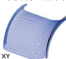
スロープXY Y面の基本形状から1斜面に対して 加工定義することができます。
