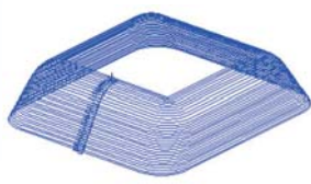
等高線 XY面から基本形状、XZ面から斜面形状を指定します。 仕上げ・荒取りが選択、荒取りは下穴、ヘリカル等アプローチ指定有り。
